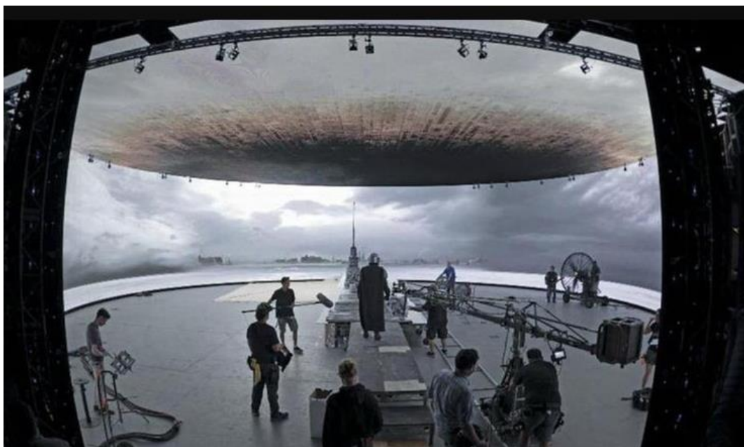
Рисунок 2– Кадр с места съемки сериала «Манадлорец», с использованием технологии «Stagecraft», где актер стоит на фоне экранов с изображением 3д-локации [5]
