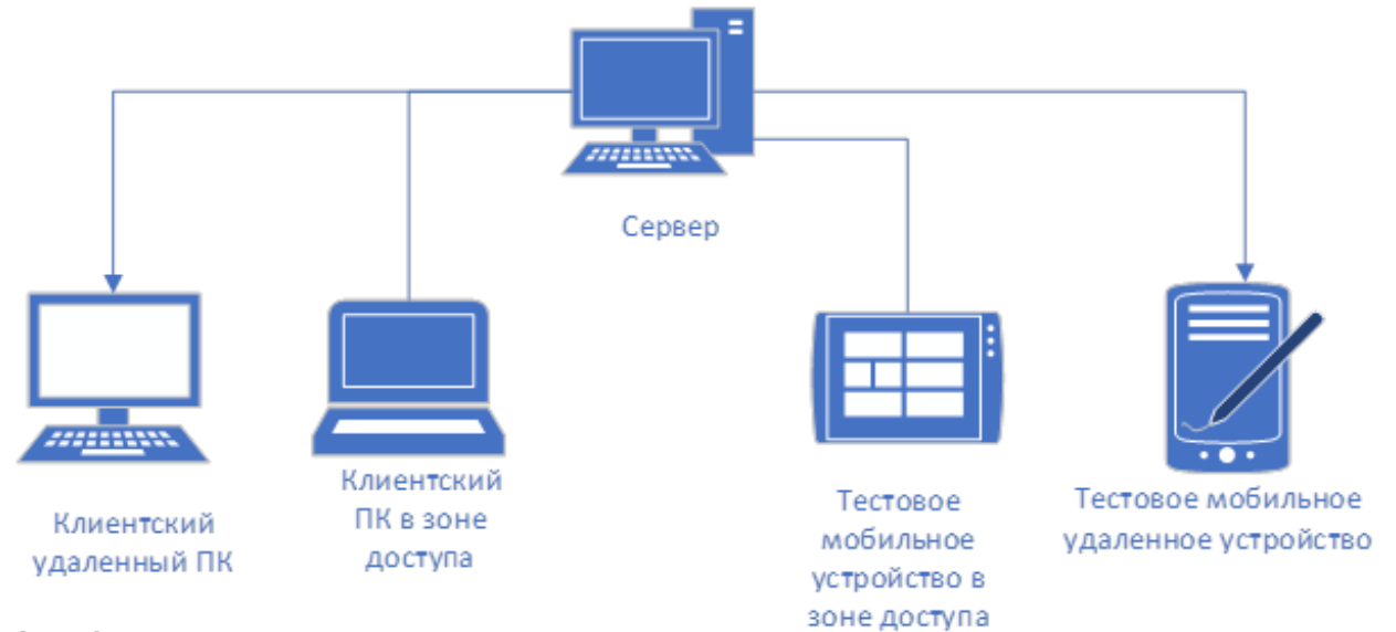
Рисунок 8 - Схема аппаратного обеспечения проектируемой ИС
