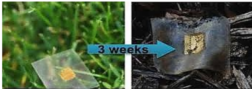
Рисунок 7 – Представлен процесс биоразложение в природе биоразлагаемого транзистора
