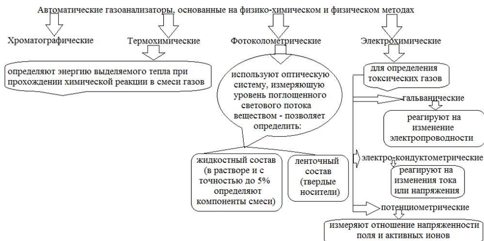
Рисунок 1 – Классификация автоматических газоанализаторов
