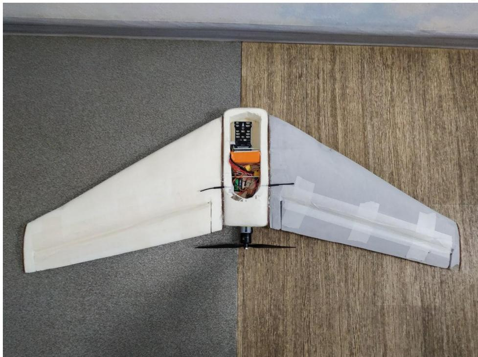
Этап 5: 23.03.2020 – Первые полевые испытания БПЛА: крыло пролетело 4 метра, после чего, потерпело крушение, в следствии неисправности правого элевона.
