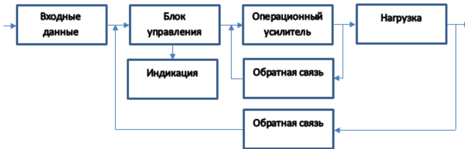
Рисунок 1 – Блок-схема электронной нагрузки
